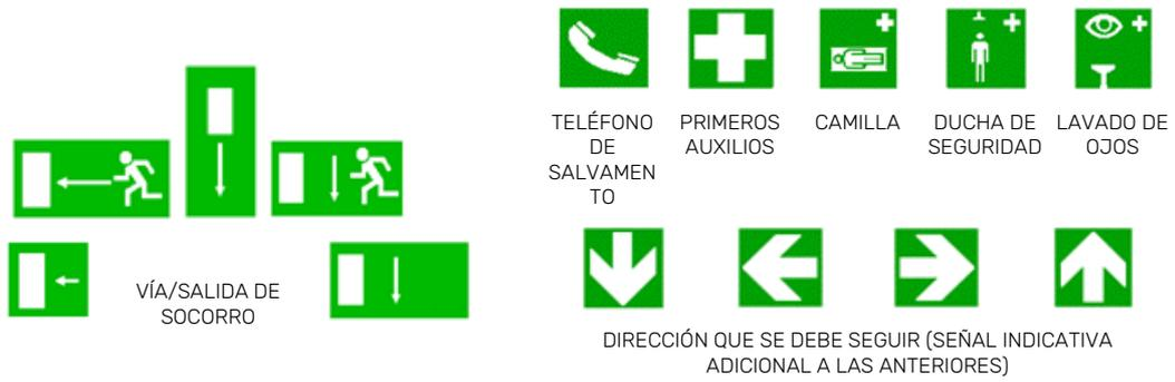
La señalización de las vías y salidas de evacuación y de los equipos de salvamento o socorro deberá ser visible en todo momento por lo que, ante un posible fallo del alumbrado normal, dispondrá de fuentes luminosas incorporadas interna o externamente, o bien será fotoluminiscente.
