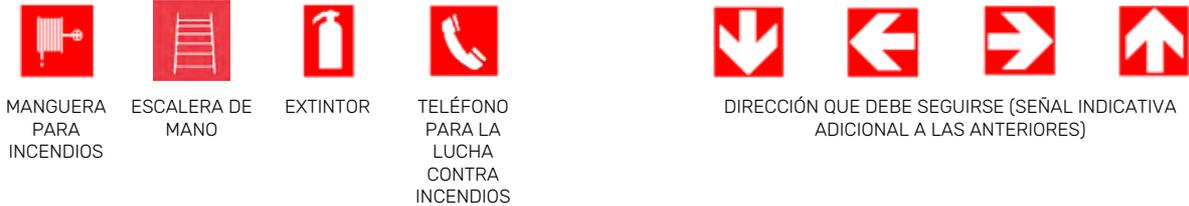
Por su parte, la Norma UNE 23033-1:2019 (Seguridad contra incendios. Señalización de seguridad. Señales y balizamiento de los sistemas y equipos de protección contra incendios) establece que la señalización de los medios de protección contra incendios se realizará utilizando el rojo como color de seguridad (el cual deberá cubrir como mínimo el 50% de la señal) y siendo el color de contraste el blanco/amarillo fotoluminiscente:
