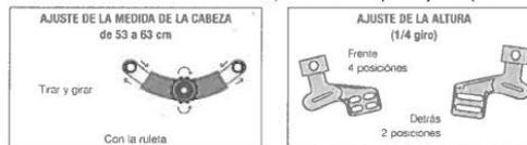
Para utilizar en altura, debe ajustarse el barbuquejo, mediante el pasador y el velcro de sujeción. Para bajar/subir el visor se girarán las manetas laterales.
