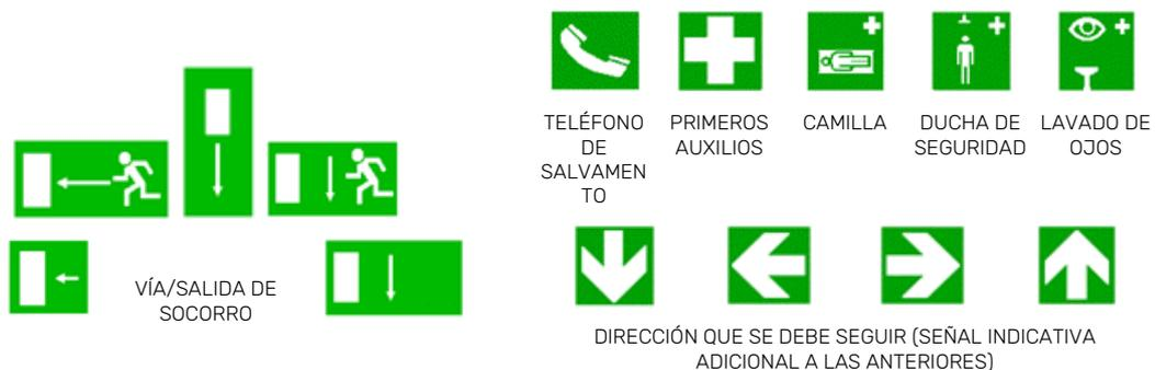
La señalización de las vías y salidas de evacuación y de los equipos de salvamento o socorro deberá ser visible en todo momento por lo que, ante un posible fallo del alumbrado normal, dispondrá de fuentes luminosas incorporadas interna o externamente, o bien será fotoluminiscente.
